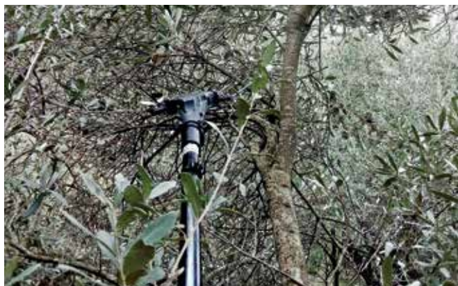
Η κεφαλή του ελαιοραβδιστικού εισχωρεί ακόμα και σε περιπλεγμένα κλαδιά ακλάδευτων δέντρων, αδειάζοντάς τα από τους καρπούς.
