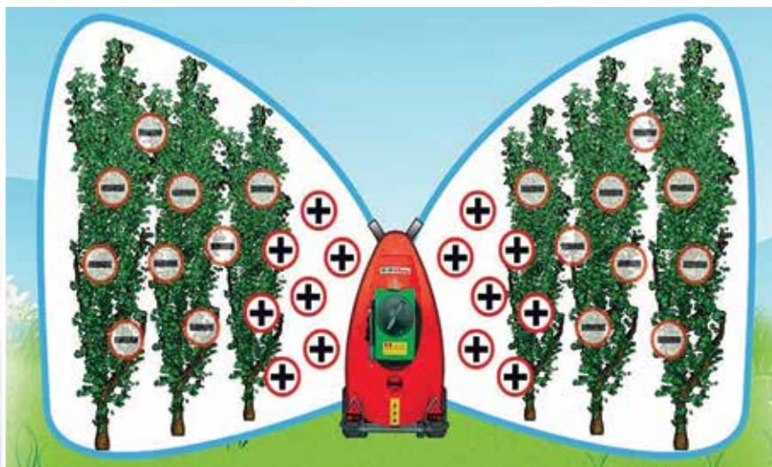
Ψεκασμός με σύστημα ηλεκτροστατικού ψεκασμού (Πηγή: Tifone, 2025)
