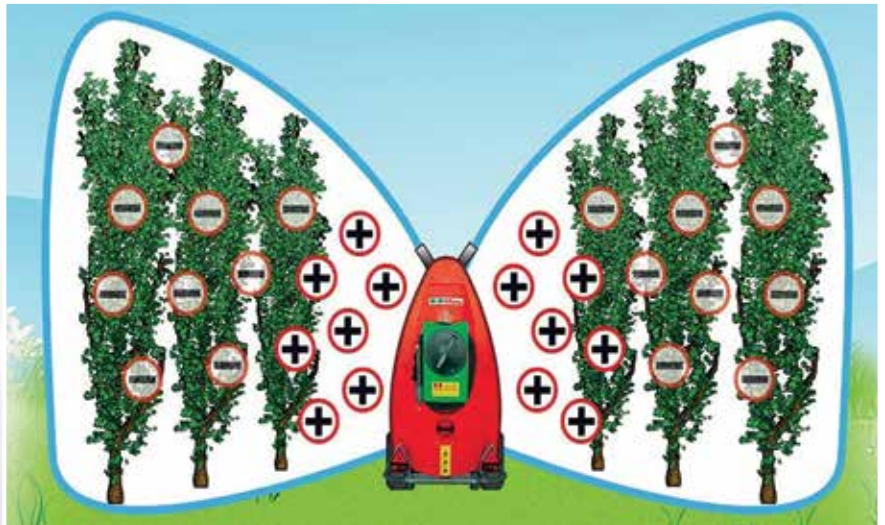
Ψεκασμός με σύστημα ηλεκτροστατικού ψεκασμού (Πηγή: Tifone, 2025)
