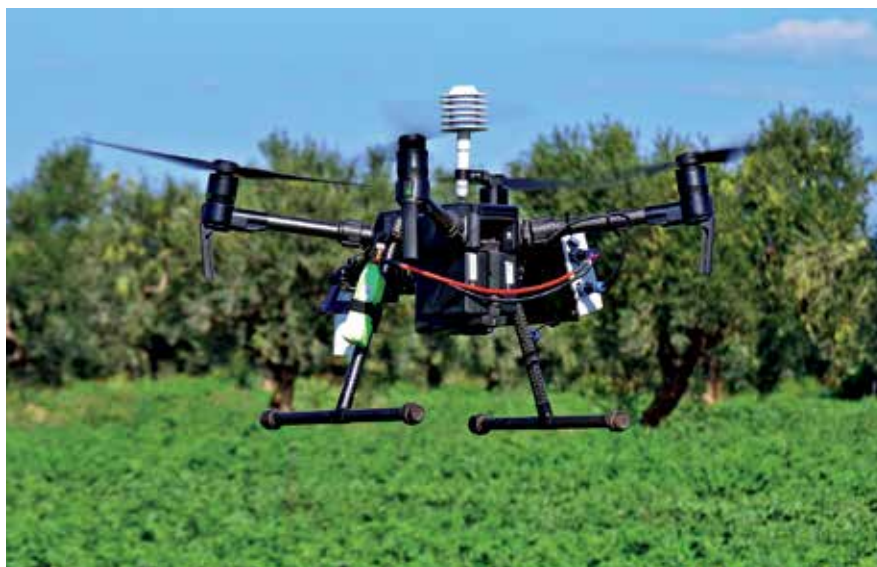
ΕΙΚΟΝΑ 1: Ιπτάμενος μικρομετεωρολογικός σταθμός στην καλλιέργεια πατάτας.
